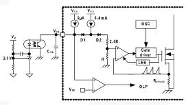
Figure 16. Pulse-Width-Modulation Circuit
