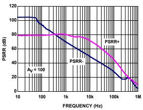
FIGURE 14. ISL28272 PSRR vs FREQUENCY
